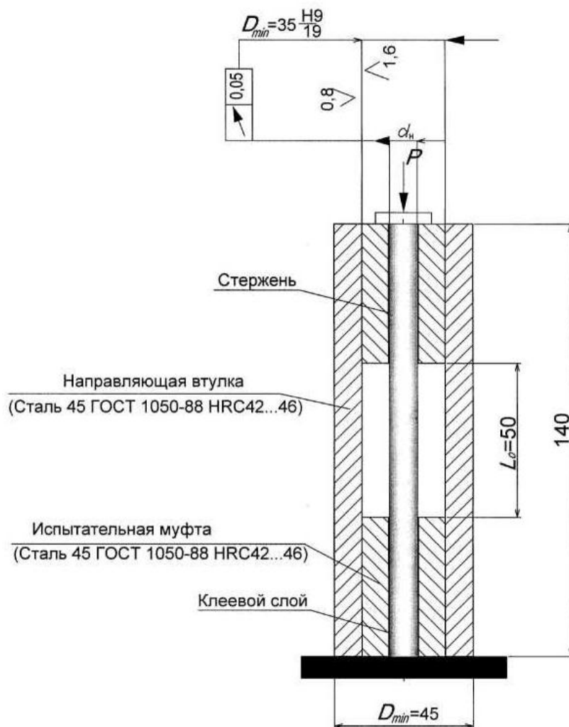
Рисунок В.2 – Приспособление для испытания образцов на сжатие
